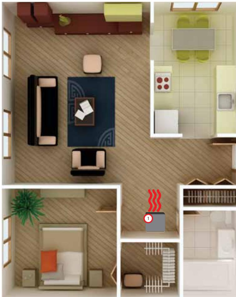
Le stufe Pasian permettono di riscaldare gli ambienti in cui sono installate ed i locali adiacenti grazie alla presenza della ventola frontale di espulsione dell'aria controllata elettronicamente. Possono bruciare pellet, nocciolino di oliva, mais miscelato e gusci triti.
