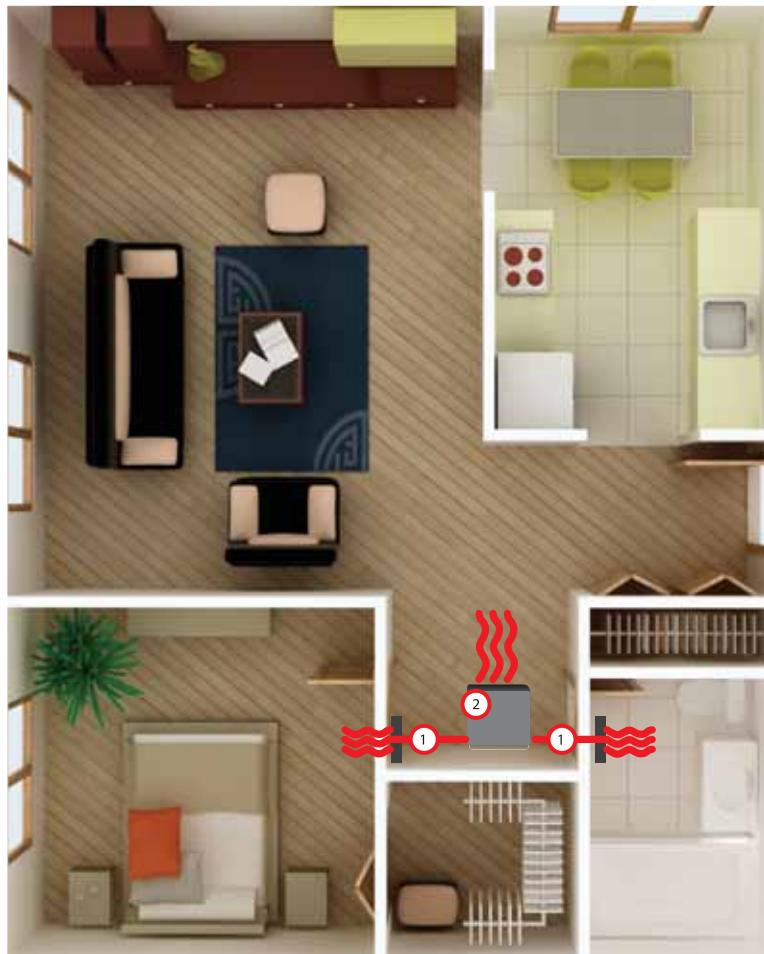
Le stufe canalizzate Pasian permettono di riscaldare anche gli ambienti adiacenti a quello in cui è installata la stufa grazie alla presenza di una uscita posteriore di aria calda con motore indipendente. Possono bruciare pellet, nocciolino di oliva, mais miscelato e gusci triti.
